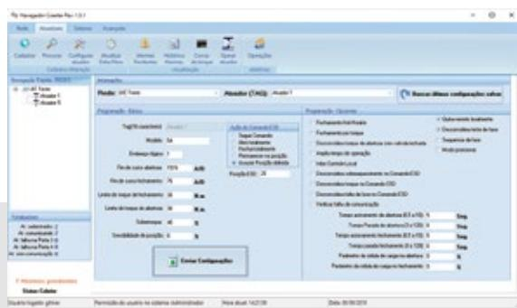
Software para configuración y control de los actuadores para ambiente Windows. Tiene alarmas configurables y permite diagnosticar fallas de los actuadores, de la red de comunicación y formatear bancos de datos operativos.
